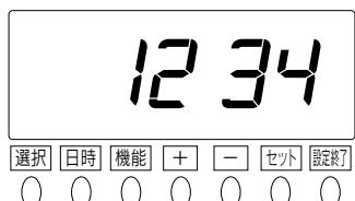
1 選択ボタンと日時ボタン(日時設定モード)、または選択ボタンと機能ボタン(機能設定モード)を同時に約3秒間押します。
