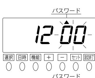
2 □ボタンを押して表示の点滅を“12”に合わせ、次にセットボタンを押します。このとき表示の点滅は“上2桁”から“下2桁”に移ります。
