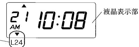
“L24”に“▼”が表示されていない場合は、24時間以内に1度も受信に成功していないので、タイムスタンプTP-8を送信機からのタイムリンクの無線電波を受信できる位置に移動してください。
