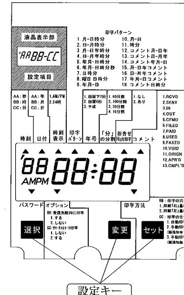
各設定は、液晶表示を見ながら選択キー、変更キー、セットキーを使って行うことができます。
