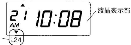
送信機の送信ボタンを押してから、1分経過しても“L24”に“▼”が表示されない場合は、タイムスタンプTP-8を送信機からのタイムリンクの無線電波を受信できる位置に移動してください。
