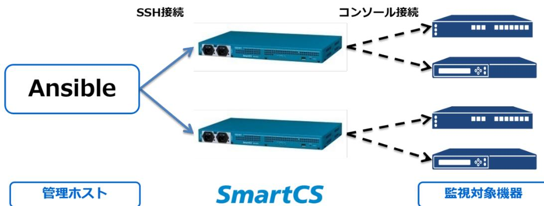
従来は、Telnet または SSH プロトコルを使い、SmartCS のシリアルポートに接続して直接ネットワーク機器のコンソールオペレーションを実行していましたが、Ansible を使う事で、手動で行っていたオペレーション内容を Playbook に記述して実行する事が可能となります。
