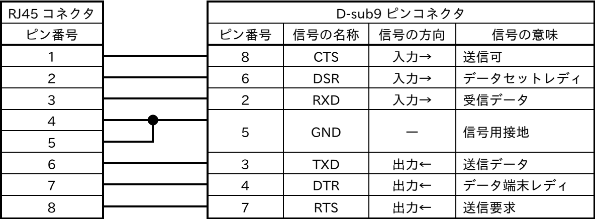
図 5-8 NS-354 DB9-RJ45 変換コネクタの結線図
