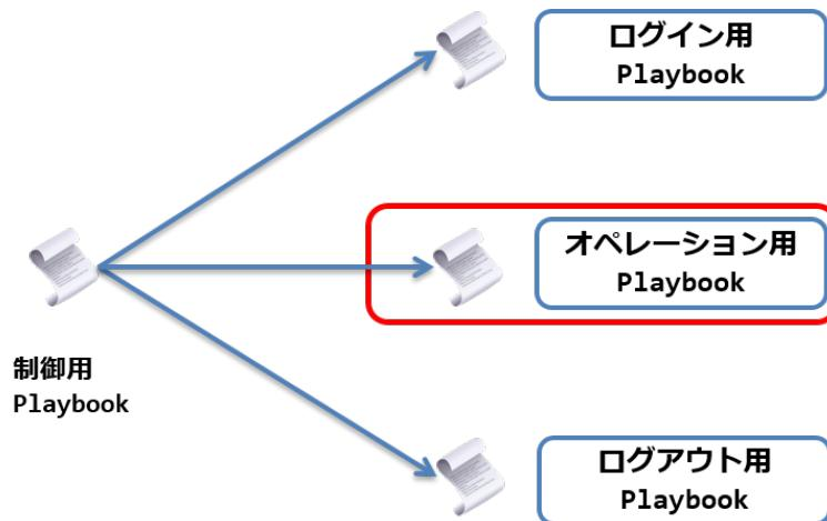
オペレーション用 Playbook では、連携するネットワーク機器ベンダーのモジュールを指定し、実行したいコマンドを記述します。ネットワーク機器への接続には、SSH トランスペアレント接続機能(sshxpt)を有効化する際に開放した TCP ポートを使用します。
