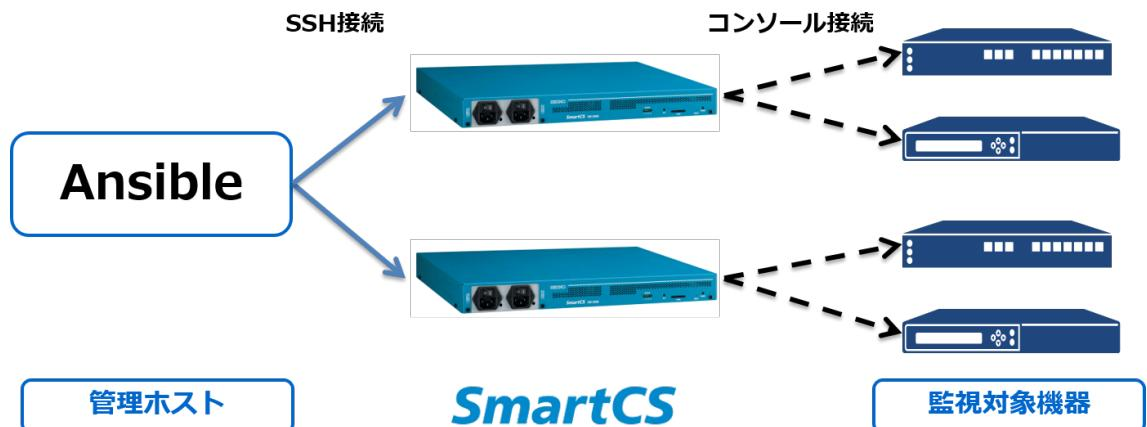
従来は、Telnet または SSH プロトコルを使い、SmartCS のシリアルポートに接続して直接ネットワーク機器のコンソールオペレーションを実行していましたが、Ansible を使う事で、手動で行っていたオペレーション内容を Playbook に記述して実行する事が可能となります。
