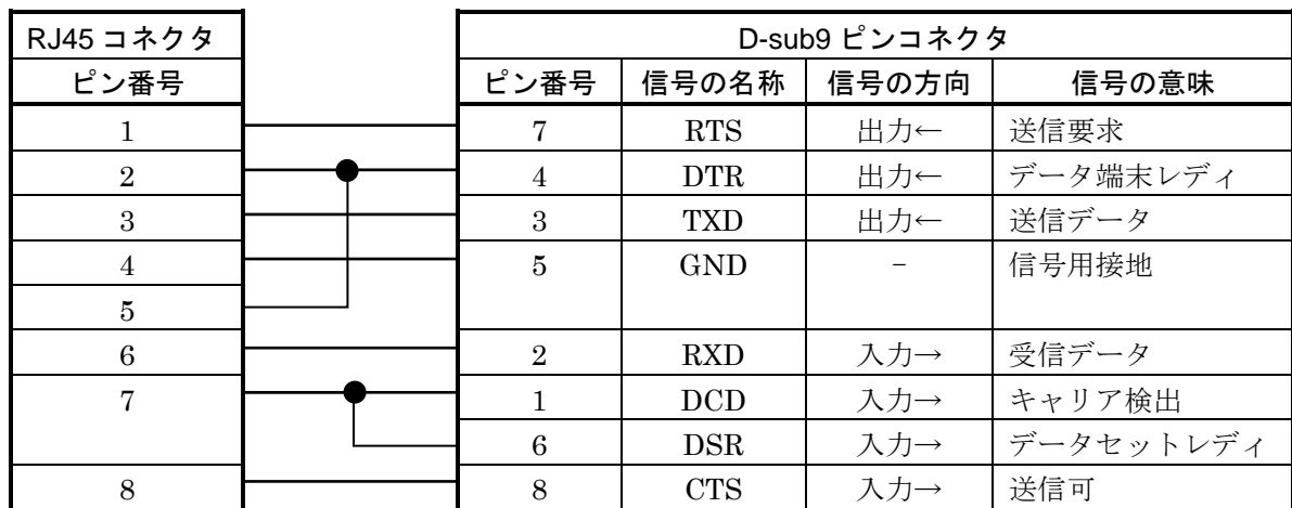
図 B-6 NS-490 DB9-RJ45 変換コネクタ(クロス)の結線図
