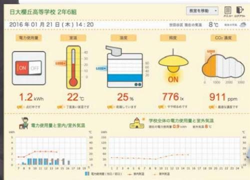
校内に設置した「ミスター省エネ」のセンサーで計測した、電力使用量や温度、湿度、二酸化炭素濃度などを、リアルタイムで見られるようにしたタブレット端末の画面
