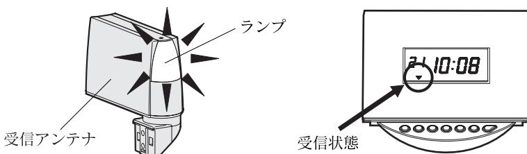
受信アンテナを本体に取り付けた状態で受信しやすいところに設置できない場合は、本体背面のケーブル収納庫にあるケーブルを引き出すことで、受信アンテナを電波の受信しやすいところに設置できます。詳しくは、前述の「壁掛けの方法」を参照してください。
