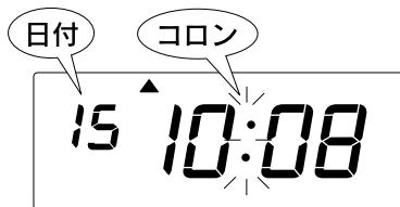
④ 設定開始/終了ボタンを押して、設定状態から通常のご使用状態に戻します。「日付」「時刻」の表示になり、コロンが点滅しているのを確認してから表示フタをつけてご使用ください。
