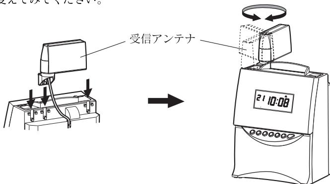
受信状態を確認するために、強制受信を行わせることができます。強制受信が始まると、本体の表示ならびに受信アンテナに内蔵されているランプが点滅しますので、それを参考に受信しやすい場所ならびに受信アンテナの向きを調整してみてください。強制受信については、後述の「強制受信」を参照してください。
