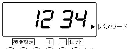
③ 例では、パスワード下2桁は“34”にします。+ボタンを押して表示の点滅を“34”に合わせ、次にセットボタンを押します。
