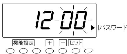
② 例では、パスワード上2桁は“12”にします。+ボタンを押して表示の点滅を“12”に合わせ、次にセットボタンを押します。このとき表示の点滅は“上2桁”から“下2桁”に移ります。
