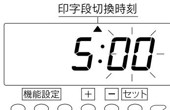
② **[+]**ボタンを押して“5”時に合わせ、次に**セット**ボタンを押します。これで“時”的設定ができました。このとき表示の点滅は“時”から“分”に移ります。
