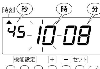
これにより、日時設定モードの場合は「時刻」の設定画面に、機能設定モードの場合は「締日」の設定画面になり、設定の変更が可能になります。
