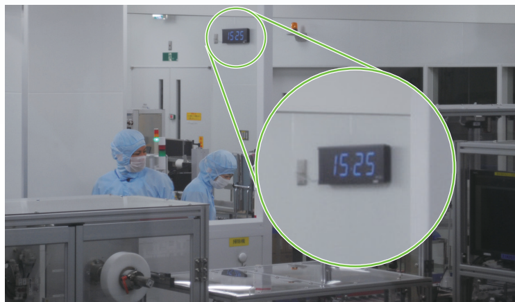
包装室内のNTPクロック
