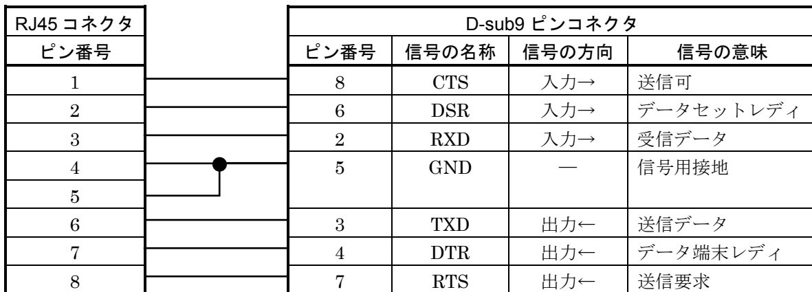
図 B-4 NS-354 DB9-RJ45 変換コネクタの結線図
